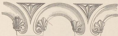
Rundbogenfries an der Refektorienbrücke.
