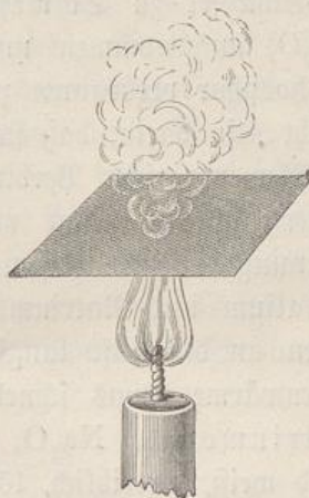
Fig. 8. Niederdrücken einer Flamme mittels eines Drahtnetzes.
