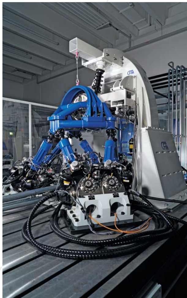
Prüfstand zur Hardware-in-the-Loop (HiL)-Simulation mechatronischer PKW-Achsen (© Heinz Nixdorf Institut)
