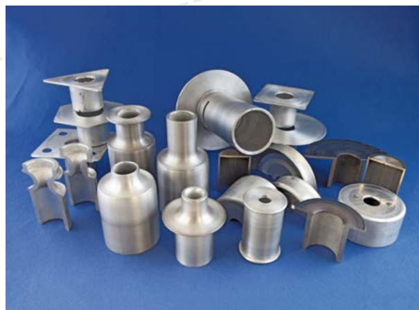
Multifunktional gradierte Strukturen, hergestellt mittels Reibdrücken
