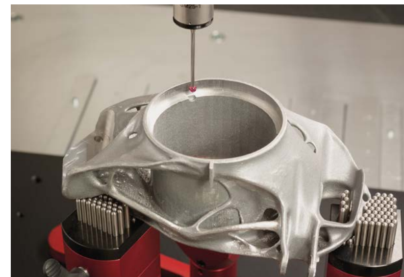
Mit dem Laserschmelz-Verfahren gefertigter Radträger wird auf der Koordinatenmessmaschine vermessen.
