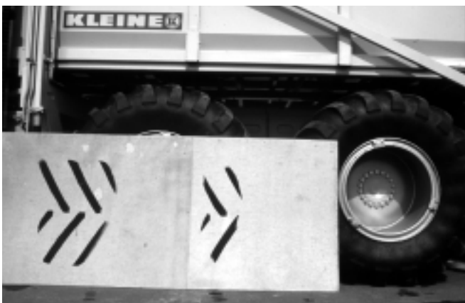
Bodenaufstandsflächen beim Rübenroder mit 3 bar und 2 bar Reifendruck bei vollem 25 t Bunker. Mit über 2 bar sollte keine Erntemaschine auf dem Boden arbeiten und die Fruchtbarkeit verschlechtern.
