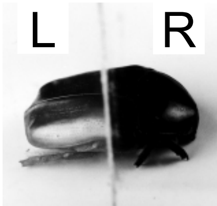
Abb. 2: Ein Rosenkäfer, durch links (L) und rechts (R) drehende Zirkularpolarisatoren betrachtet. Die Flügeldecken reflektieren links zirkular polarisiertes Licht (L), durch einen Rechtsfilter (R) erscheinen sie schwarz.
