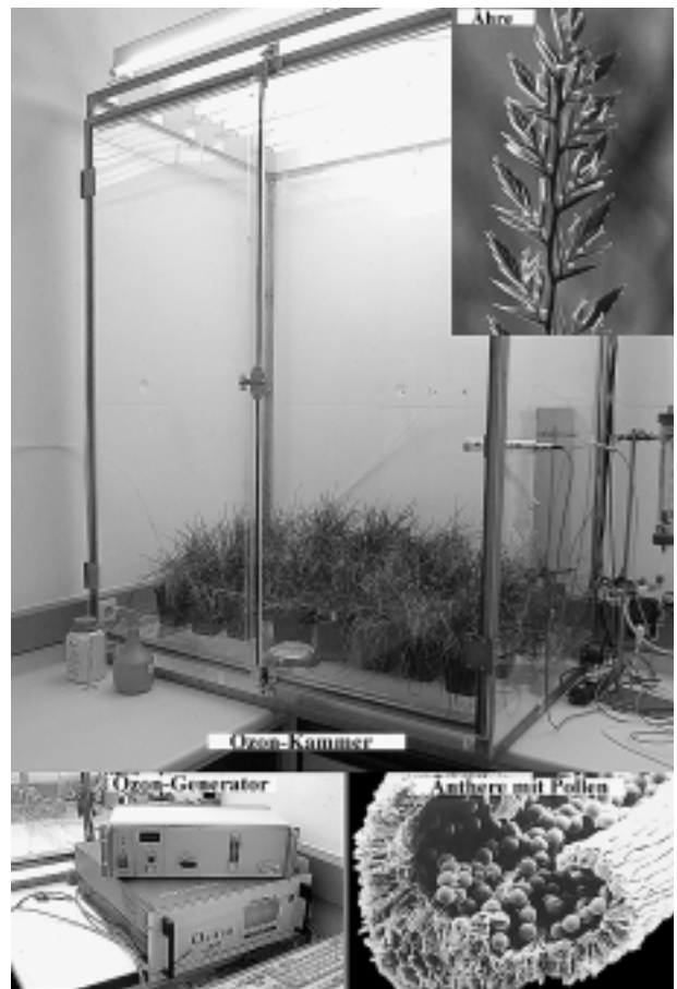
Begasungskammer Paderborn: Regelung vom Temperatur und Ozon sowie ständige Überwachung von Ozonwerten, Temperatur und Luftfeuchte; variable Begasungsdesigns; Gewinnung größerer Probenmengen über das ganze Jahr. Ozon-Kammer mit Lolium perenne (Lp).
