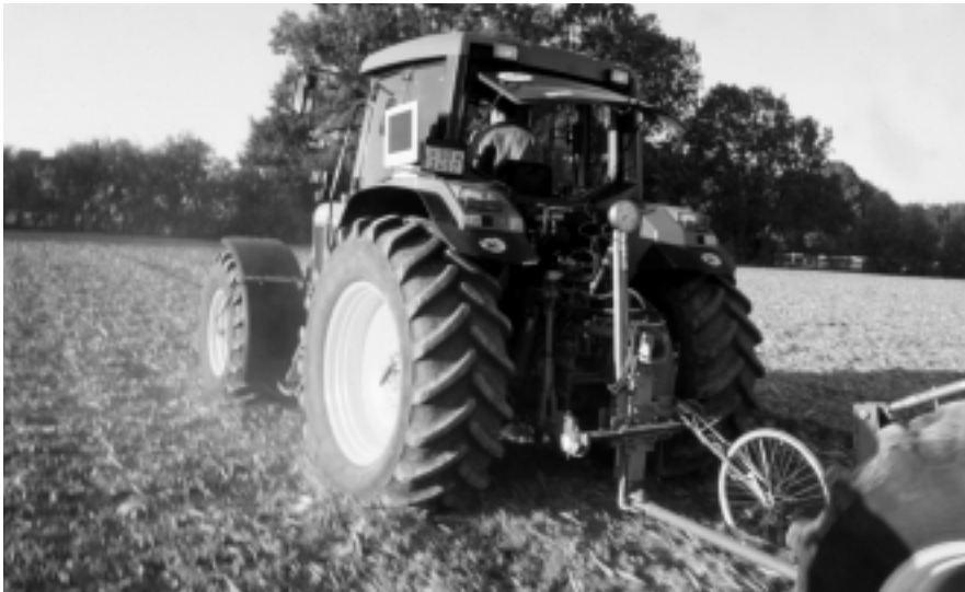
Zugkraftmessung auf dem Acker mit Zug- und Bremstraktor, eingebauter Messtechnik und, zum Beobachten der aktuellen Zugkraft für Studenten und Praktiker, der Bildschirm auf dem Kotflügel.
