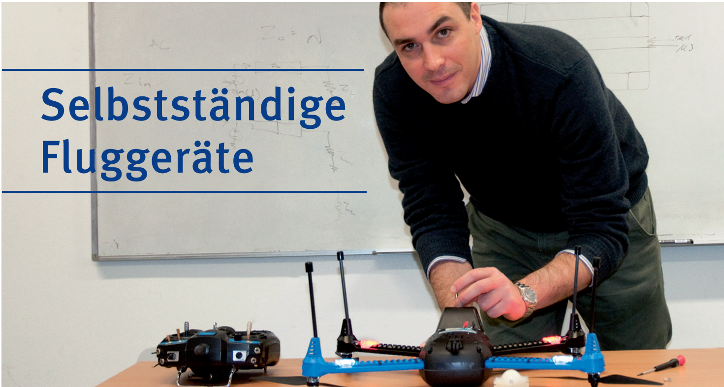
Montage des Radarsystems (vorne im Bild) auf der Drohne
