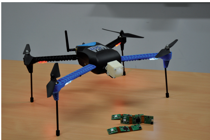
Das gesamte Radarsystem mit einzelnen flexiblen Platinen (im Vordergrund), Gehäuse und Drohne im Hintergrund
