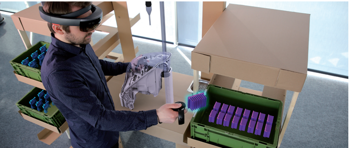
Mit einer Datenbrille projiziert das Fraunhofer IEM virtuelle Bauteile und Werkzeuge auf den Papp-Prototypen.
