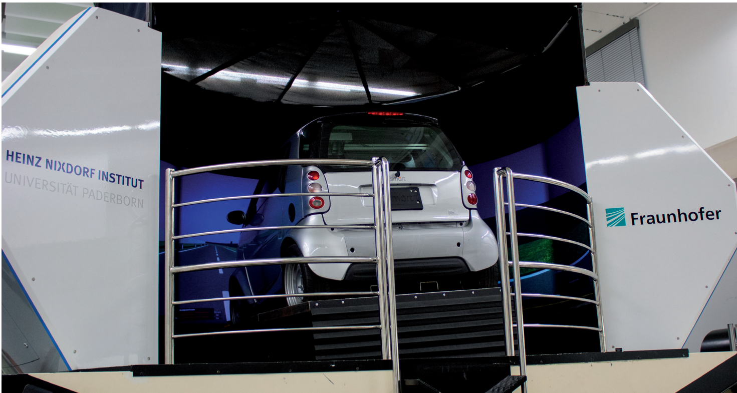
Der Fahrsimulator des Heinz Nixdorf Instituts mit dynamischem Bewegungssystem
