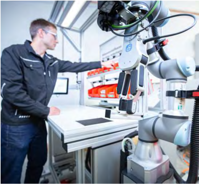
Bei der Montage übernimmt der Cobot nachgelagerte Arbeitsschritte und entlastet damit den Werker.
