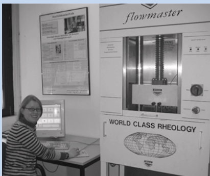
Untersuchung von Wandgleiteffekten an einem modifizierten Hochdruck-Kapillarrheometer.
