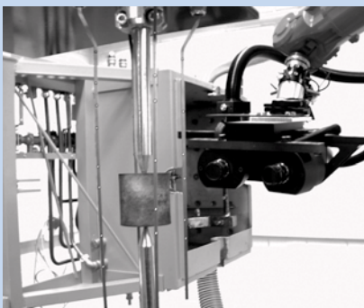
Automatische 3D-Vermessung einer deformierten Struktur
