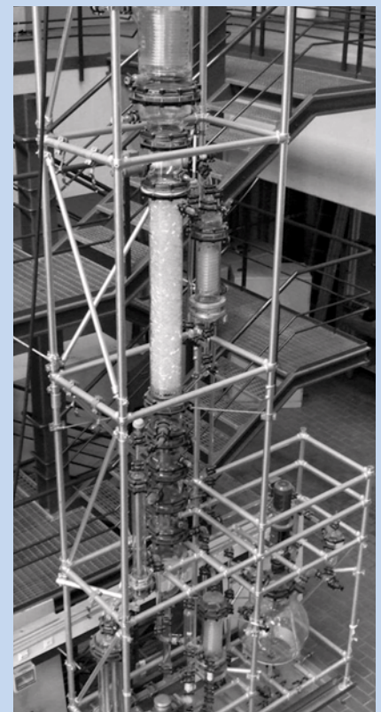
Rektifikationskolonne aus Glas mit regellosen Füllkörpern im Technikum des Lehrstuhls.
