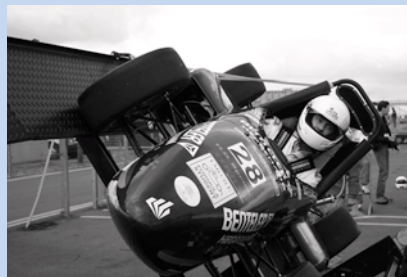
Der Tilt-Table-Test ist eine von vier TÜV-Prüfungen, die das Fahrzeug vor Rennantritt bestehen muss.
