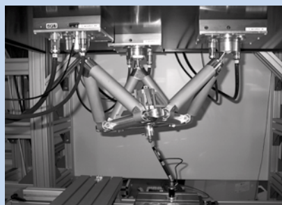
Parallelroboter TriPlanar mit Messvorrichtung zur Selbstkalibrierung
