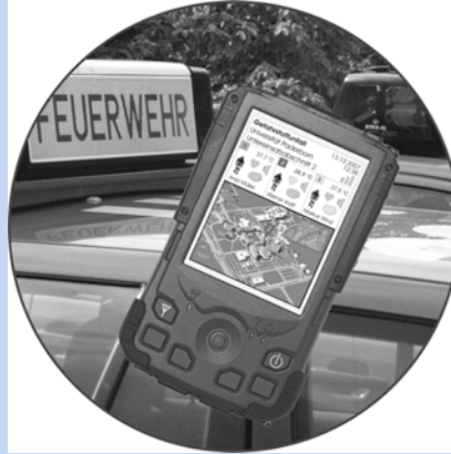
Ansicht eines Demonstrators, der aktuelle Informationen über den Belastungszustand eines Feuerwehrmannes bereitstellt
