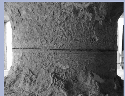
Der Bruch einer Hammermühle führte zum Produk-tionsausfall und letztendlich zu einem Rechts-streit. Dieser konnte durch bruchmechanische Untersuchungen geklärt werden.
