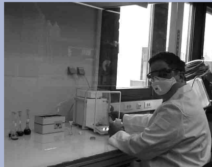
Präparation von Nanopartikel-Proben in mobiler, staubfreier Umgebung (FlowBox)
