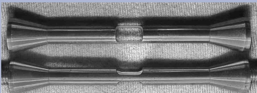
Probe zur Bestimmung der Festigkeit von gezielt eingestellten Mischgefügen
