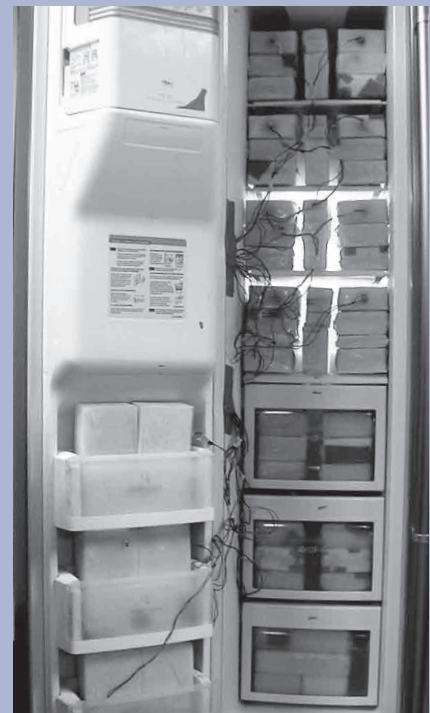
Beladung eines Gefrierfachs mit Testpaketen
