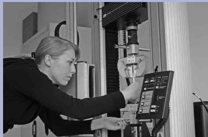
Innerhalb der ersten Projekte des DMRC sollen maßgebliche Verfahrensparameter der einzelnen Technologien und mechanische Eigenschaften (hier: Ermittlung des E-Moduls durch Zugversuche) der verwendeten Materialien ermittelt werden.
