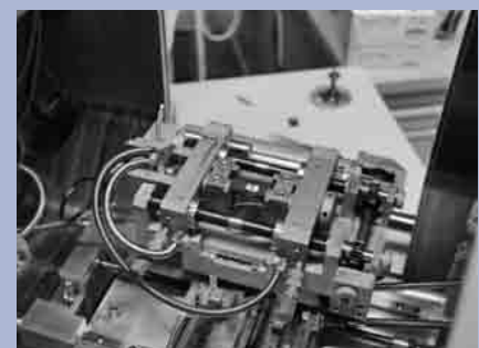
Miniatur-Lastrahmen im Rasterelektronenmikroskop zur Messung mechanischer Kennwerte im Vakuum
