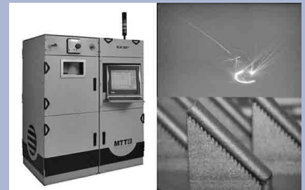
Mit Hilfe des Selective Laser Melting™ (SLM) lassen sich homogene Metallpulver partiell und schichtweise aufschmelzen, so dass komplexe metallische Geometrien entstehen. Für den Bau von Prototypen ist dies inzwischen ein gängiges Verfahren. Bei der Serienproduktion müssen, neben ökonomischen Gesichtspunkten, die mechanischen Eigenschaften bekannt sein und gewährleistet werden. Gezielte Wärmebehandlungen ermöglichen eine Eigenschaftsverbesserung der SLM-Bauteile.
