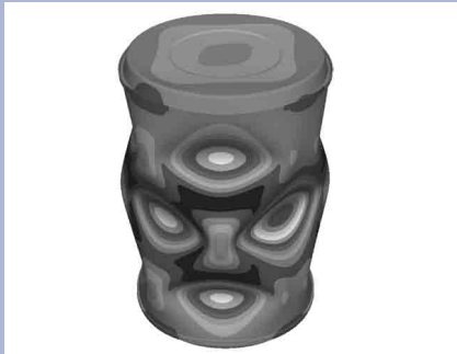
Untersuchung des Beulverhaltens eines Kunststoff-fasses bei Vertikalbelastung
