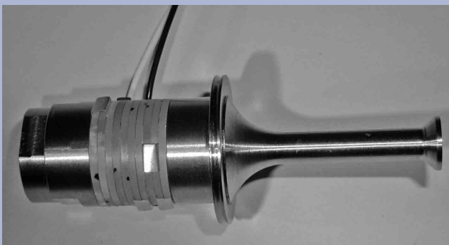
Vorgespannter Ultraschallaktor mit Scheiben aus LiNb-Einkristall
