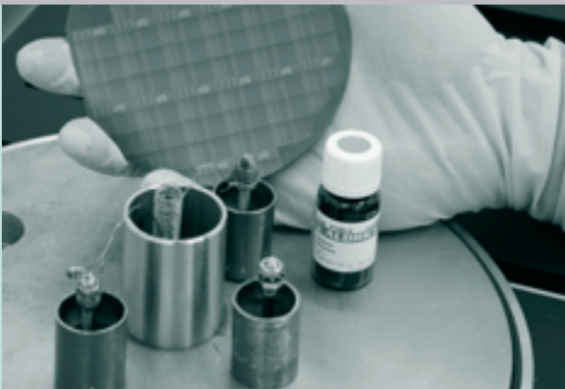
Organische Feldeffekt-Transistoren aus Pentacen auf Silizium-Substrat
