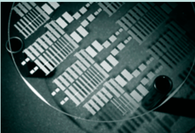
Oberflächenwellen-Feuchtesensoren auf Quarzwafer
