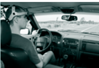
Eye-Tracking-System-Einsatz bei Testfahrten auf der Straße
