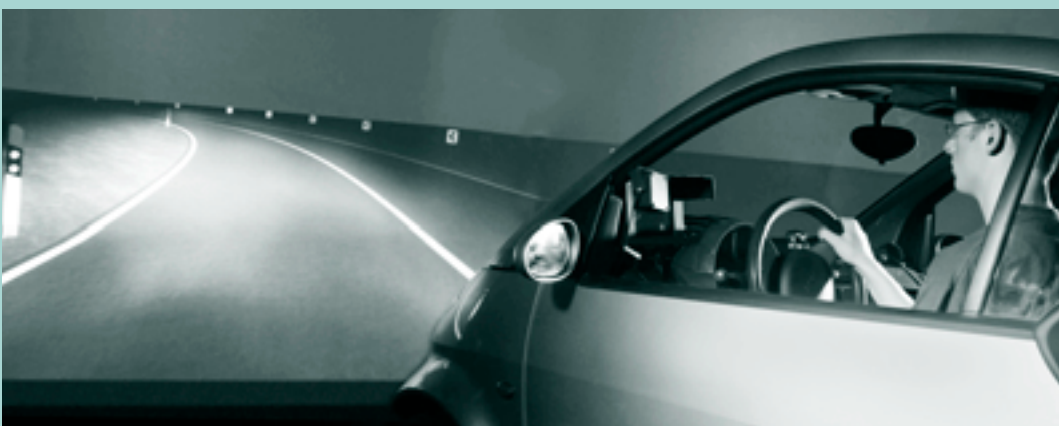
Virtual-Reality-Nachtfahrt des Simulators im L-LAB auf einer nassen Fahrbahn mit Einblendungen von Sichtweitemarken
