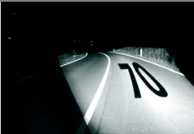
Projektion von Informationen mit einem Aktiven Scheinwerfer
