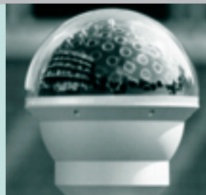
In der Arbeitsgruppe entwickelter Sensor für solare Einstrahlung
