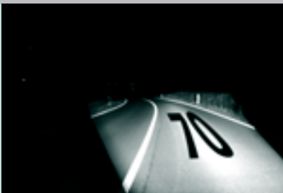
Projektion von Informationen mit einem Aktiven Scheinwerfer
