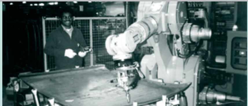
Automatisches Aufbringen des Klebstoffes für die Montage eines PKW-Daches
