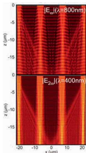
Simulation der elektrischen Felder in dem Bauelement zur Frequenzkonversion.
