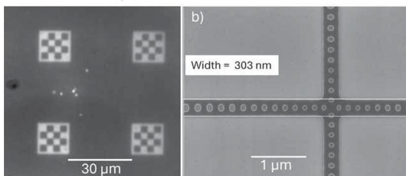
a) Kryogene Lokalisierung von einzelnen Quantenpunkten neben Schachbrettmarkern. Die hellen Punkte im Bild sind Photolumineszenz einzelner Quantenlichtquellen. b) Elektronenstrahlolithographie einer gekreuzten Nanoresonatorstruktur.
