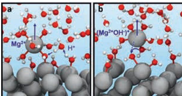
Beschreibung der fundamentalen elektrochemischen Auflösungsprozesse bei der Korrosion von Magnesium mittels ab initio Molekulardynamik:
