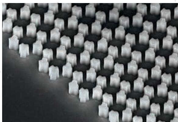
Rasterelektronenmikroskopie-Aufnahme einer nanostrukturierten Siliziumoberfläche.
