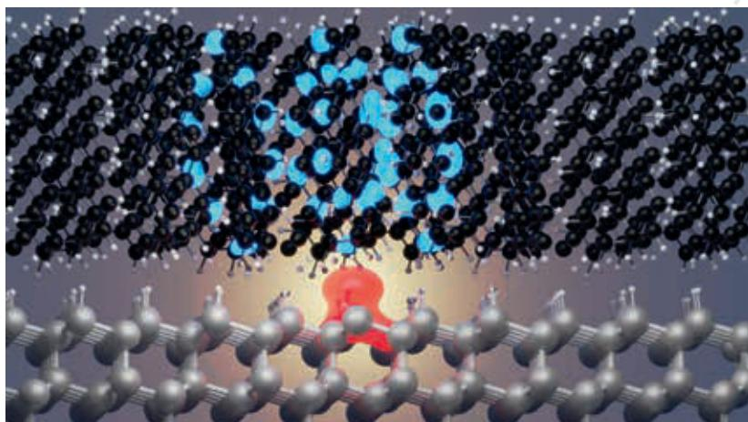
Transfer eines Exzitons in einer Tetracen-sensibilisierten Siliziumsolarzelle.
