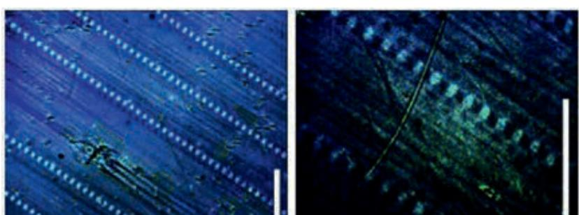
Anwendung eines ferroelektrischen Flüssigkristalls, um die elektrischen Eigenschaften eines periodisch gepolten ferroelektrischen Kristalls sichtbar zu machen.
