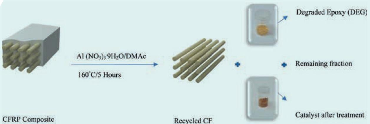
**Recyclingverfahren für das katalytische
