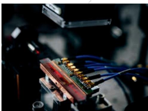
Fasergekoppelte, optische Wellenleiterprobe im geöffneten Tieftemperatur-Kryostaten zur Untersuchung optoelektronischer Effekte bei tiefen Temperaturen.
