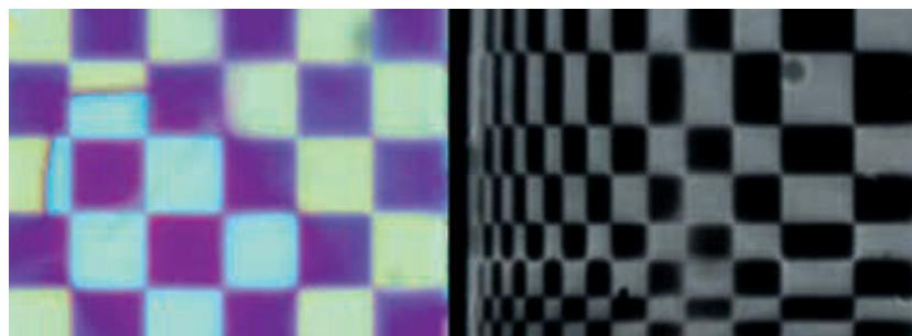
Verankerung eines nematischen Flüssigkristalls auf nanostrukturierten Oberflächen
