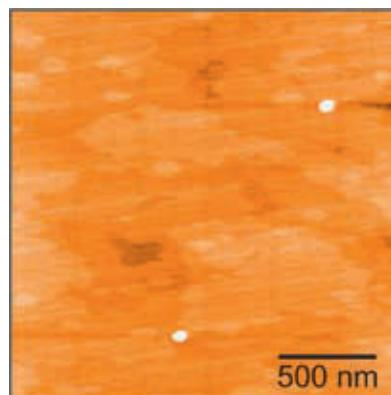
InAs-Quantenpunkte auf einer GaAs(100)-Oberfläche.
